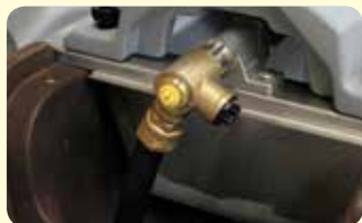
◀ Вращающееся соединение 3/4" с 2-ми направлениями: Возможно ответвление с циркулятором без дополнительного аксессуара.
